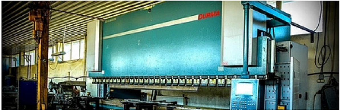
Durma hidraulikus élhajlító (400 tonnás 6000 hossz)
